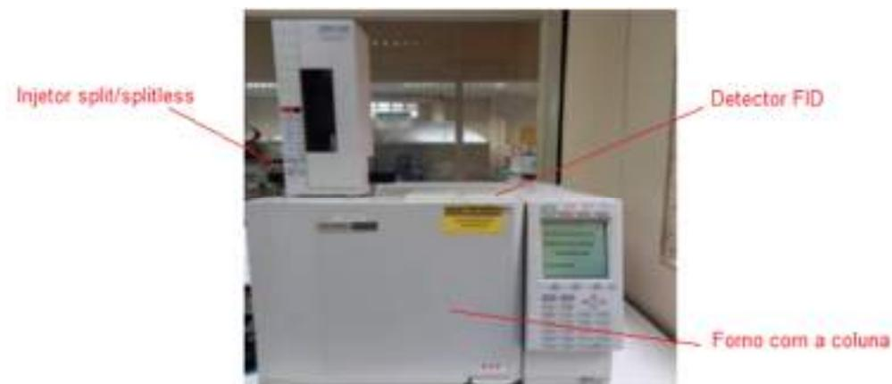
**Figura 8:** Cromatógrafo a gás modelo GC-2010A da marca Shimadzu.
