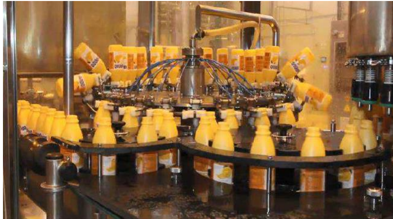
Figura 15: Processo de envase automático de suco de laranja em garrafas
