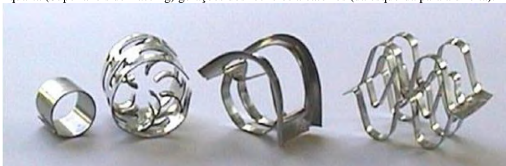
Figura 3: Primeira (Anéis de Raschig), segunda (Anéis de Pall), terceira (Selas Intalox de Metal - IMTP) e quarta (Super anéis de Raschig) gerações dos recheios aleatórios (da esquerda para a direita).
