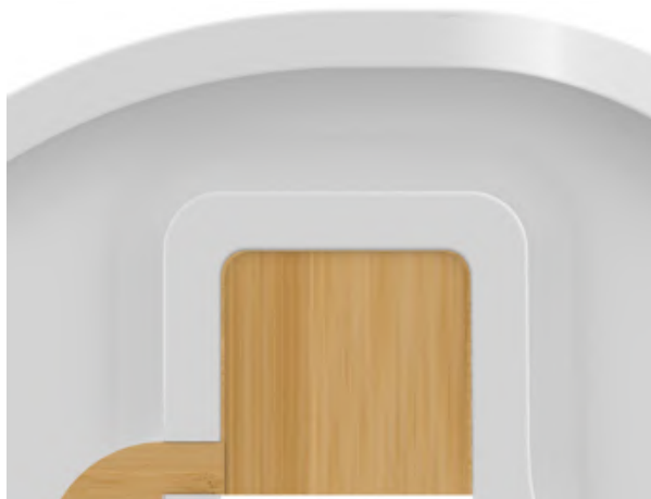
Figura 175 - Arredondamento de arestas no contato entre suporte e estrutura (arquivo da autora)
