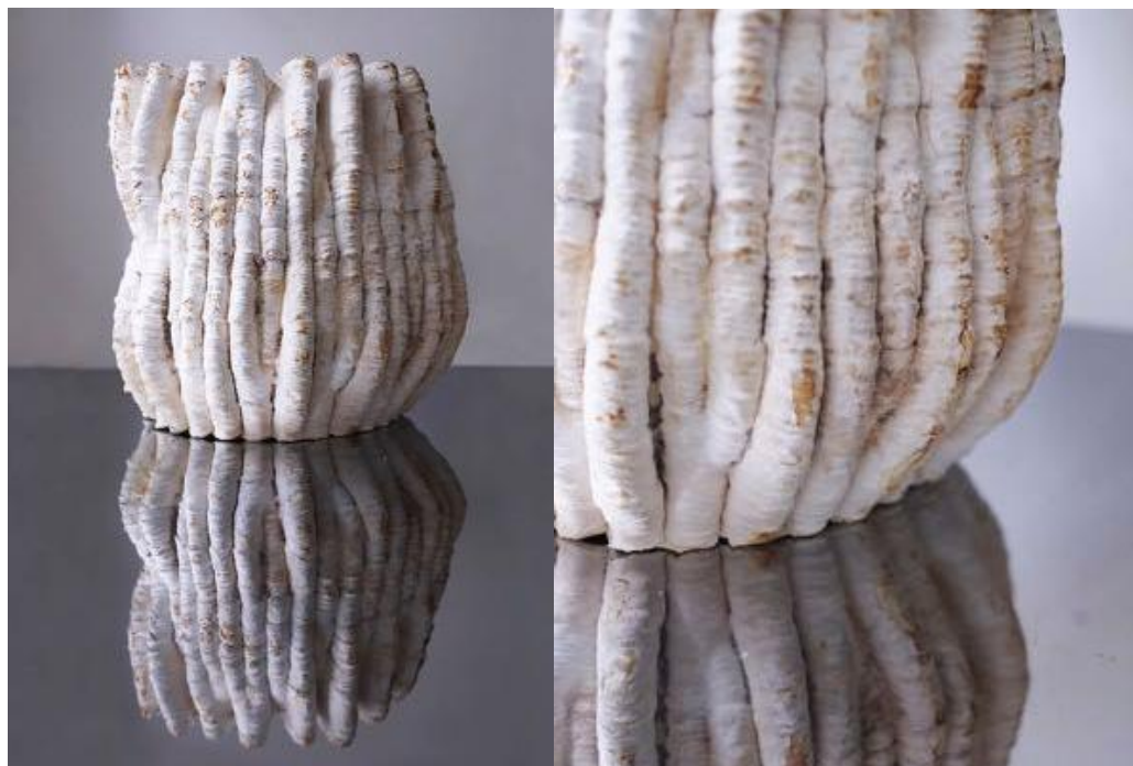
Figura 89 - Resultado de objeto impresso com pasta de micélio e copos de café. Fonte: https://www.blast-studio.com
