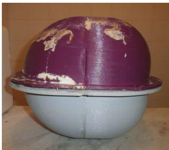
Figura 221 - Juntar as partes. Deixar o micélio crescer entre as metades para uni-las (arquivo da autora)
