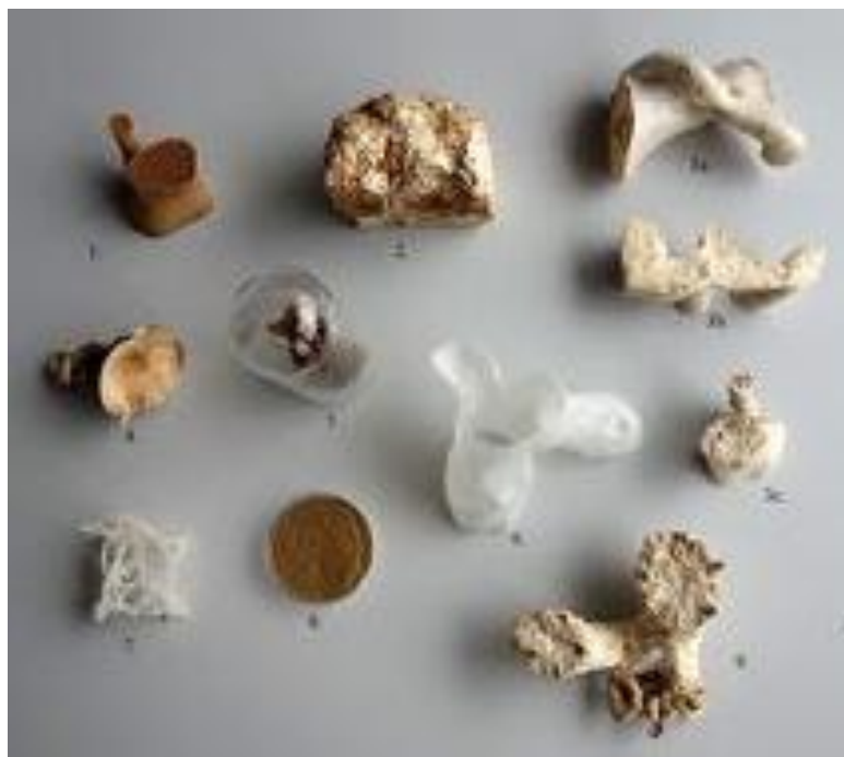
Figura 87 - Amostras de material e de impressão com substrato de palha e micélio
