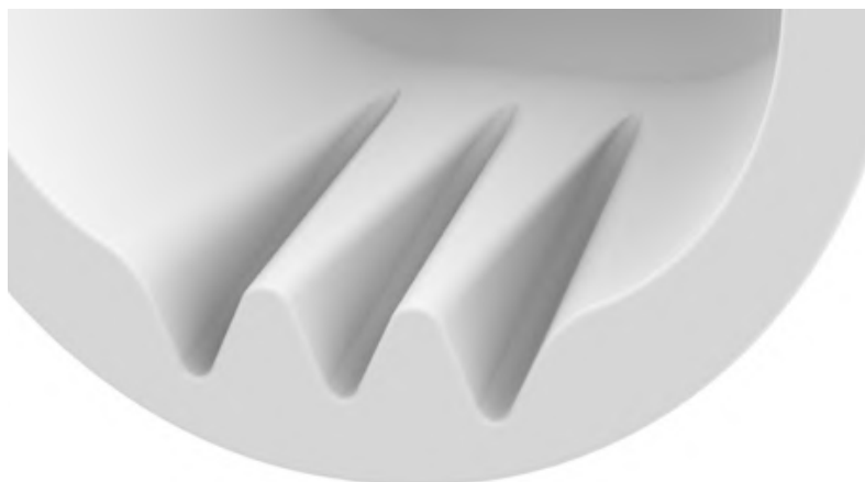
Figura 172 - Sulcos para drenagem de água (arquivo da autora)
