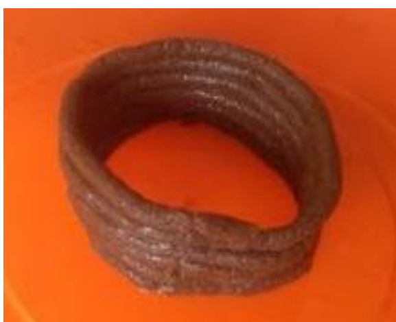
Figura 240 - Teste de pasta com pó de eucalipto e farinha cozida (arquivo da autora)
