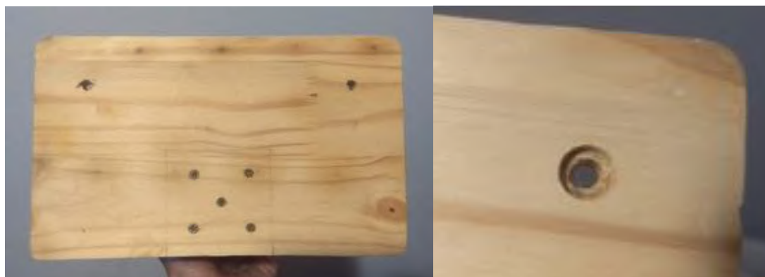
Figura 253 – União de uma parte na outra com parafuso e cola branca e detalhe do furo para prender o suporte na parede (arquivo da autora)
