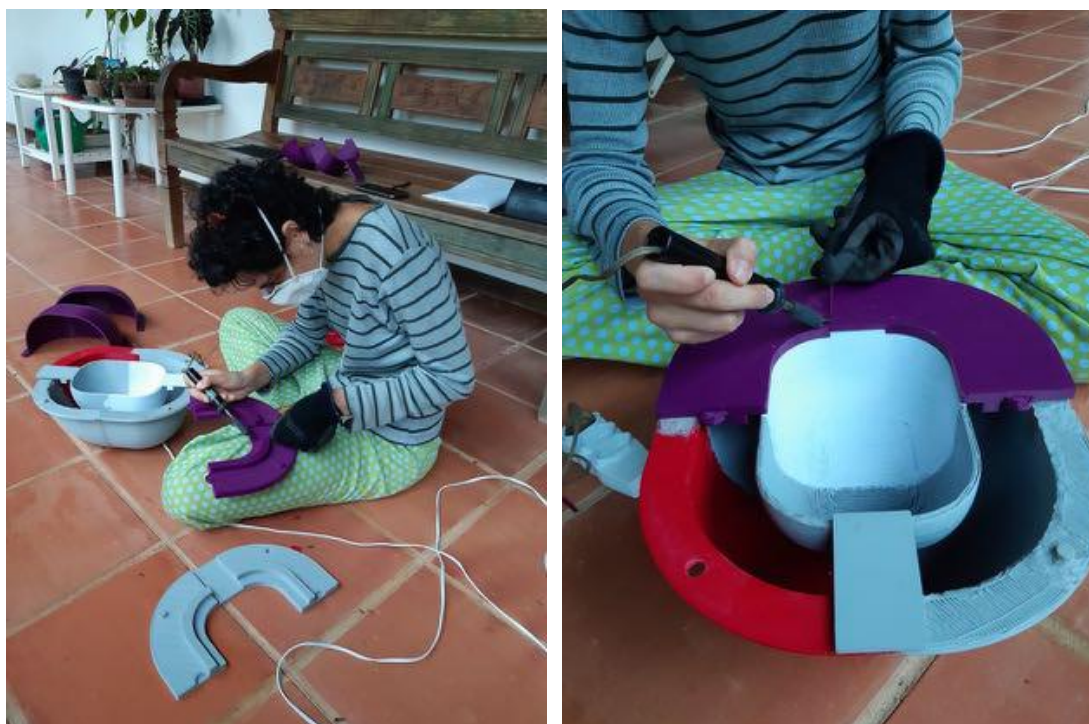
Figura 204 - União das partes do molde com calor (arquivo da autora)
