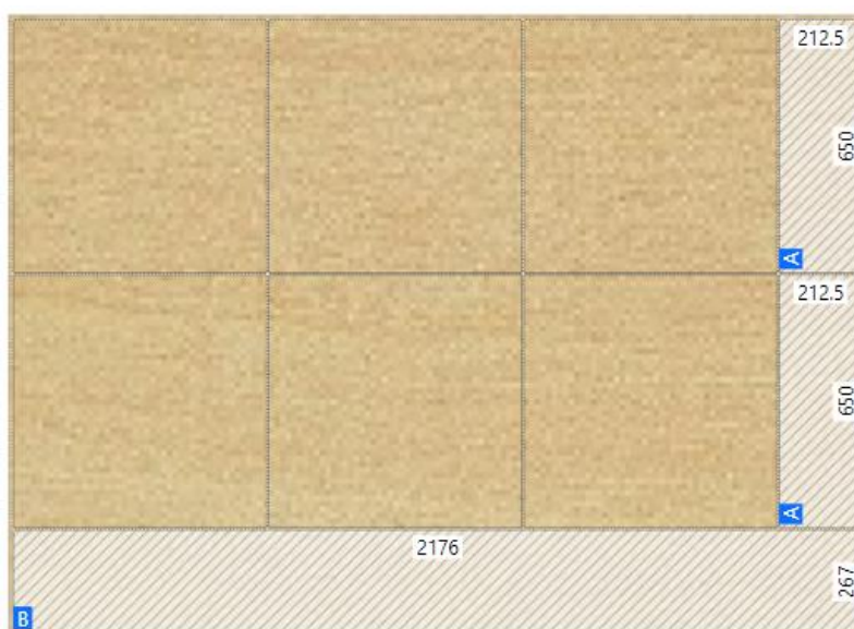
Figura 72: Plano de Corte painel de 25 mm
