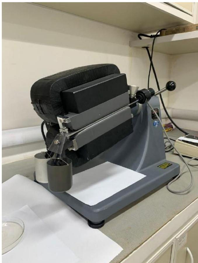
Figura 21: Separador magnético isodinâmico *Frantz*
