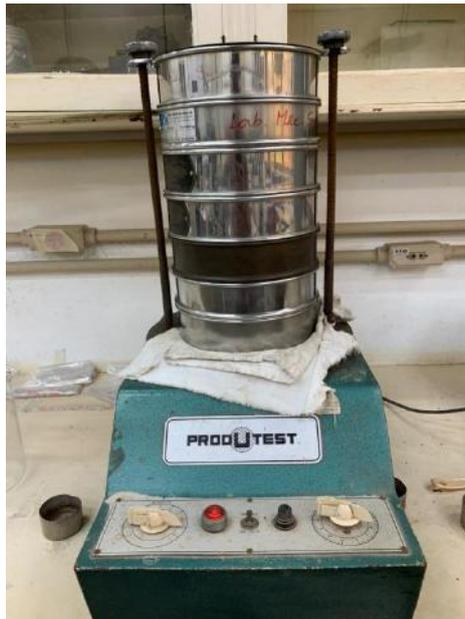
Figura 17: Conjunto de peneiras utilizado no agitador para o peneiramento fino (Fonte: Fotos do autor).
