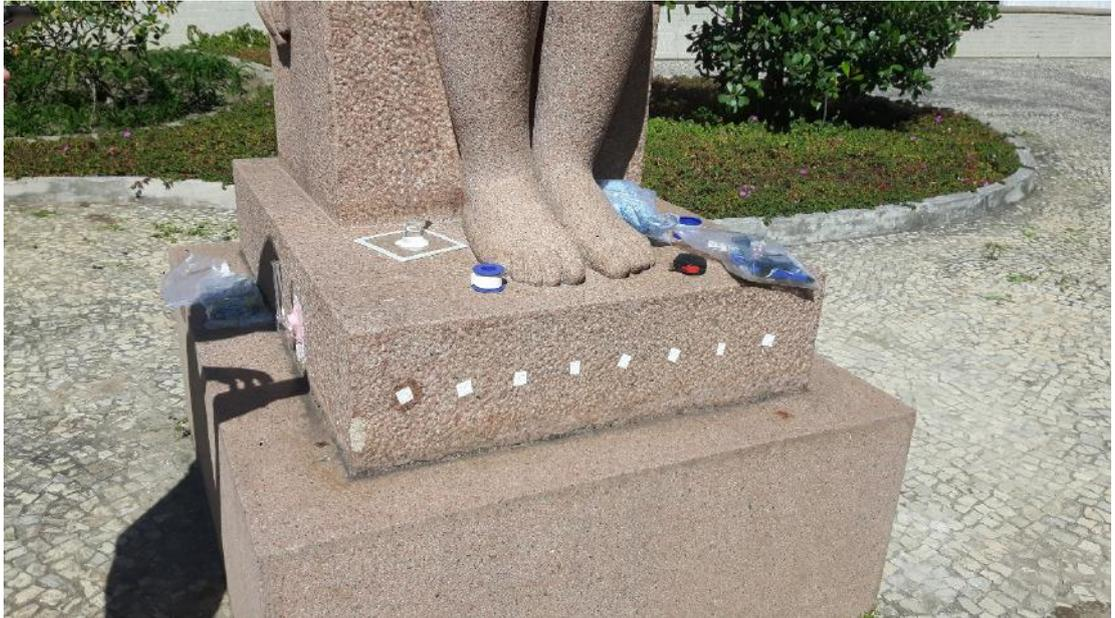
Figura 11 - Pontos de medição utilizando o *Pundit*, seguindo o método do *line scan* na parte frontal da escultura.
