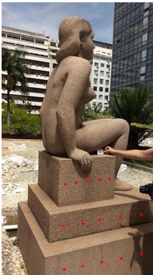
Figura 13 - Pontos de medição da colorimetria na lateral esquerda.
