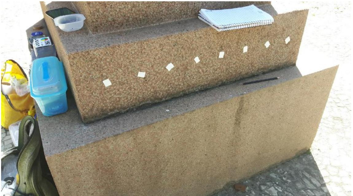
Figura 12 - Pontos de medição utilizando o *Pundit*, seguindo o método do *line scan* na parte traseira da escultura.
