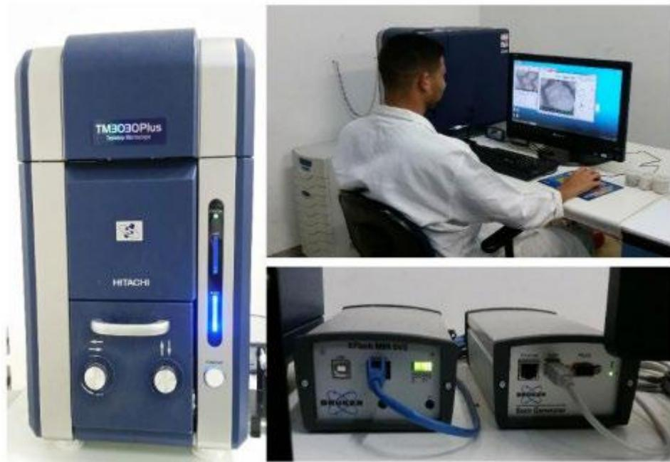
Figura 21 – MEV com EDS acoplado. (Fonte: FARIA, 2019)
