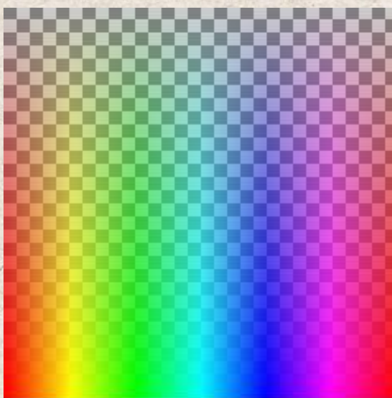
Figura 11 - Exemplo de uma imagem RGBA com porções translúcidas e transparentes, composta sobre um fundo quadriculado.
