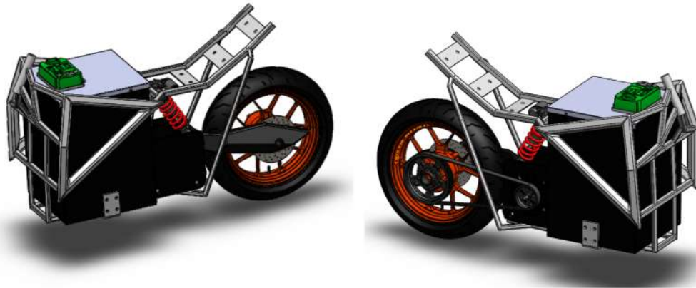
Figura 6.5: braço oscilante à esquerda e correia com polias à direita; modelagem em solidworks (Fonte: elaboração dos autores)
