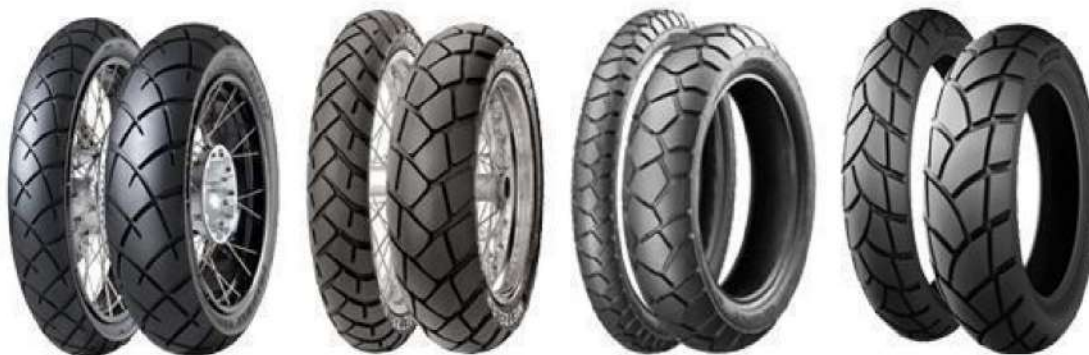
Figura 3.19: Exemplos de pneus mistos 60/40; Google imagens
