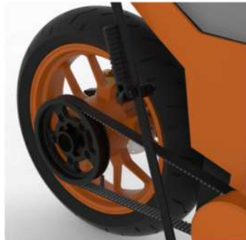
Figura 6.13: pedaleira retrátil; render em keyshot (Fonte: elaboração dos autores)
