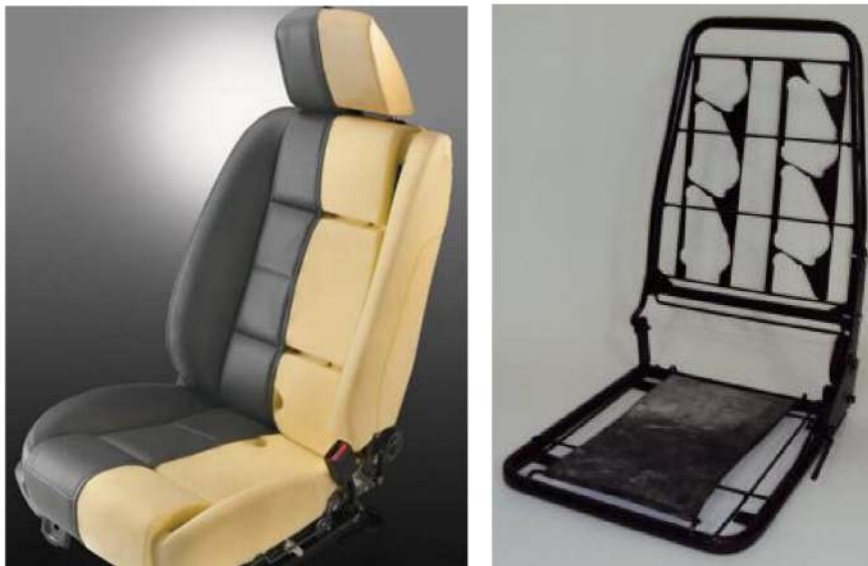
Figura 7.4: imagem de um banco automotivo (esquerda); alma de um banco automotivo (direita)
