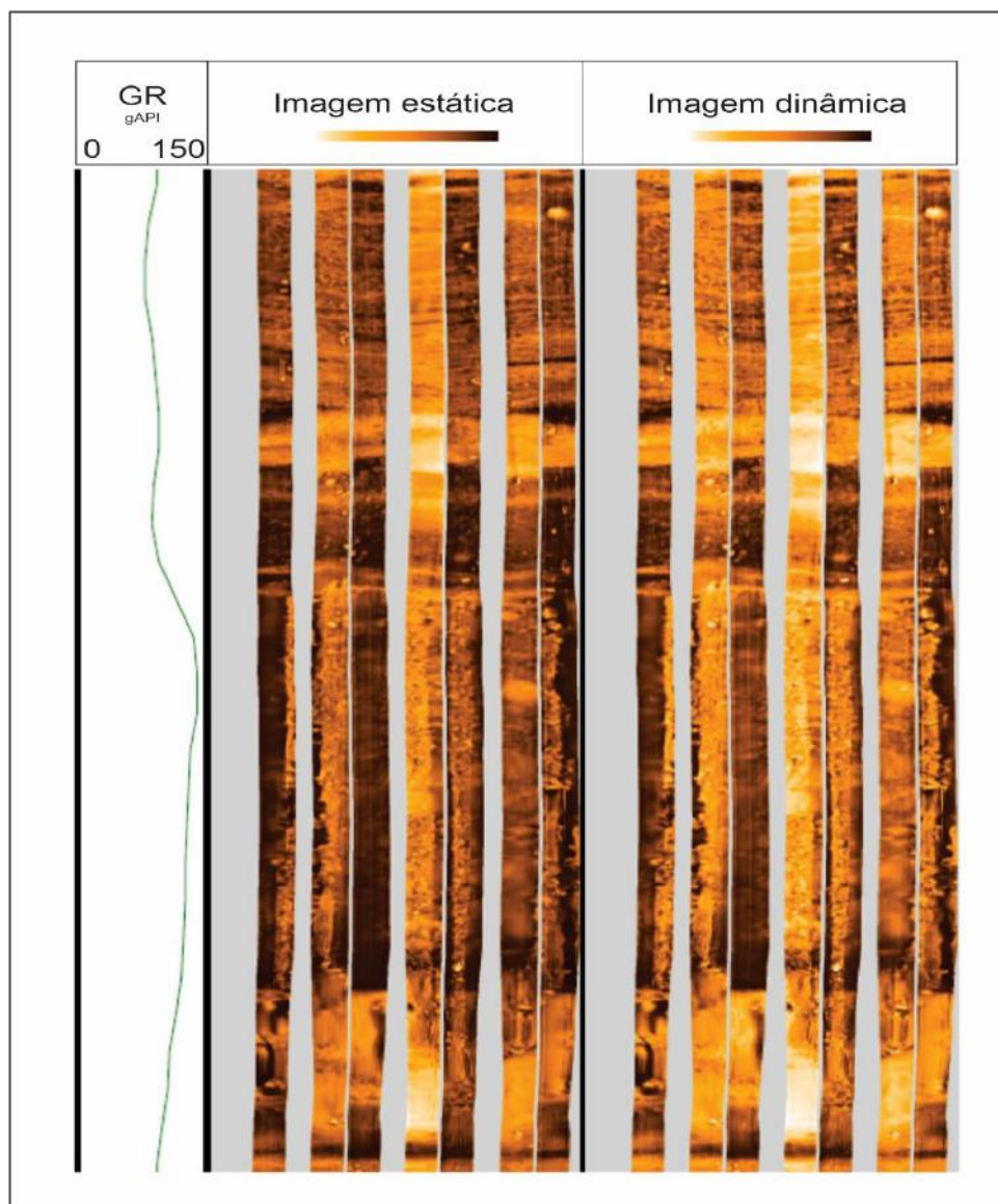
Figura 20 - Exemplo de artefato nos perfis de imagem e argilosidade associada.
