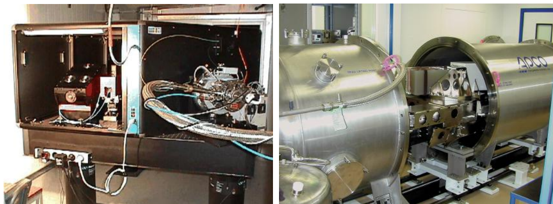
Figura 2.3: Invólucros dos espectrógrafos usados nesta análise. FEROS à esquerda e o HARPS à direita com sua câmara de vácuo aberta. Crédito das imagens: ESO.
