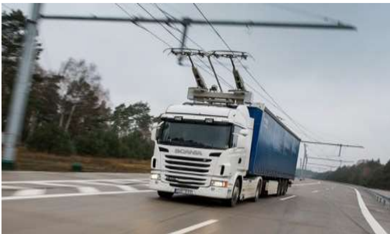
Figura 3.3 Caminhão elétrico com alimentação direta na rede elétrica
