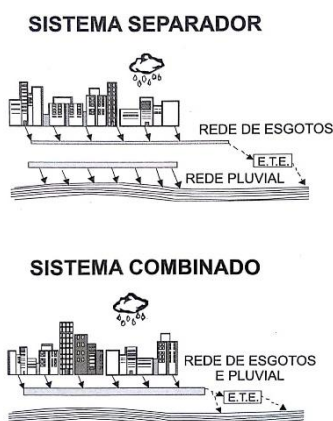
Figura 3: Variantes de sistemas de esgotamento sanitário. Fonte: von Sperling, 2005.
