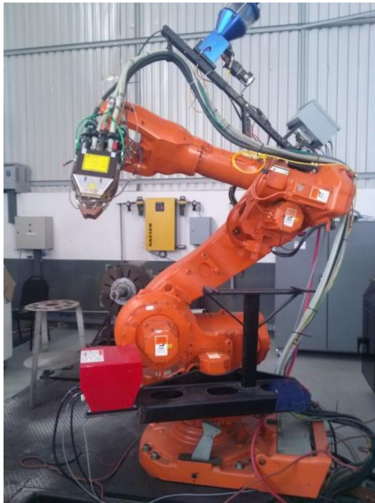
Figura 30: Célula robotizada, do processo de revestimento laser.
