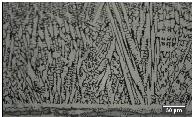
Figura 39: Microestrutura da região de interface do revestimento com uma camada, aumento de 200x.
