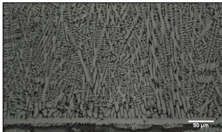
Figura 41: Microestrutura da região intermediária do revestimento com duas camadas, aumento de 200x.
