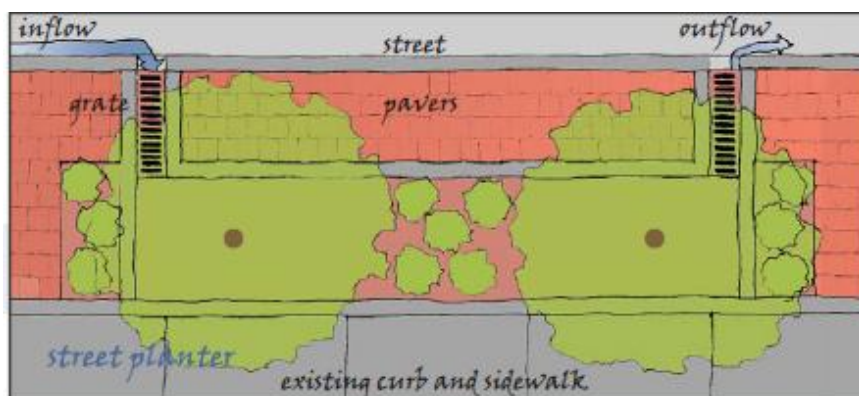
Figura 23: Vista superior de projeto de canteiro pluvial sendo incorporado à calçada
