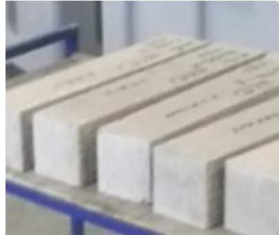
Figura 12 – Corpos de prova produzidos para os ensaios físicos e mecânicos
