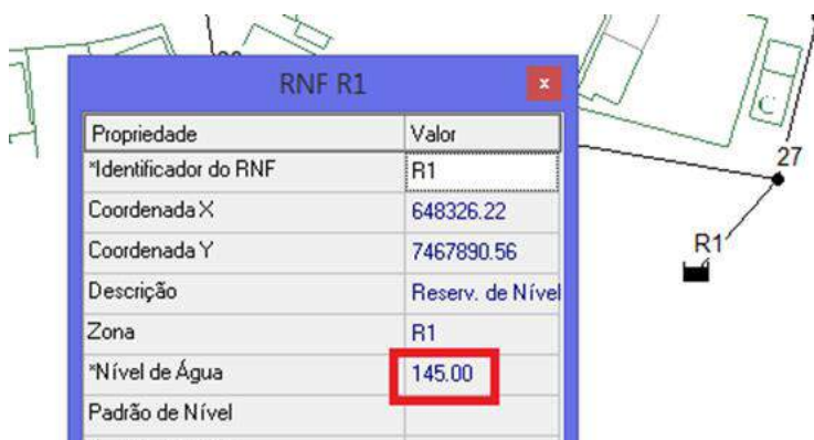
Figura 21: Imagem dos dados do reservatório no Epanet
