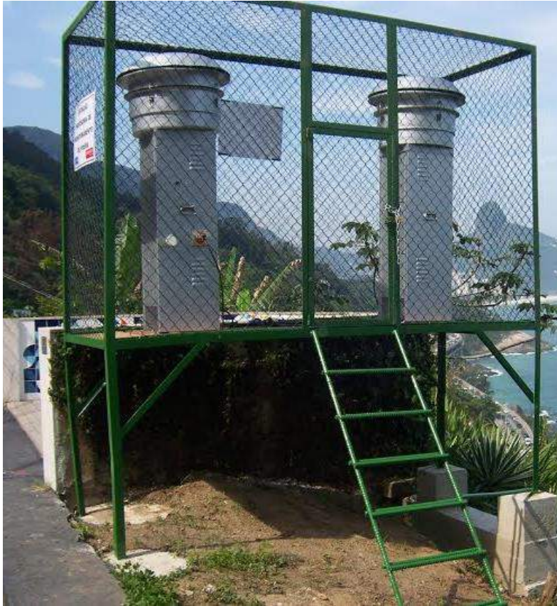
Figura 06: Hi-Vol MP10 utilizado para coleta de MP10.
