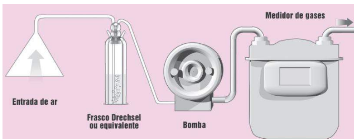
Figura 09: Configuração mínima para a amostragem de SO 2 .
