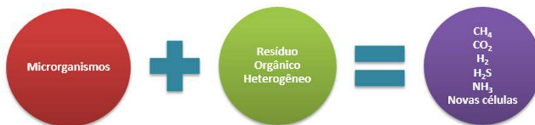
Figura 4: Esquema simplificado do processo de digestão anaeróbia
