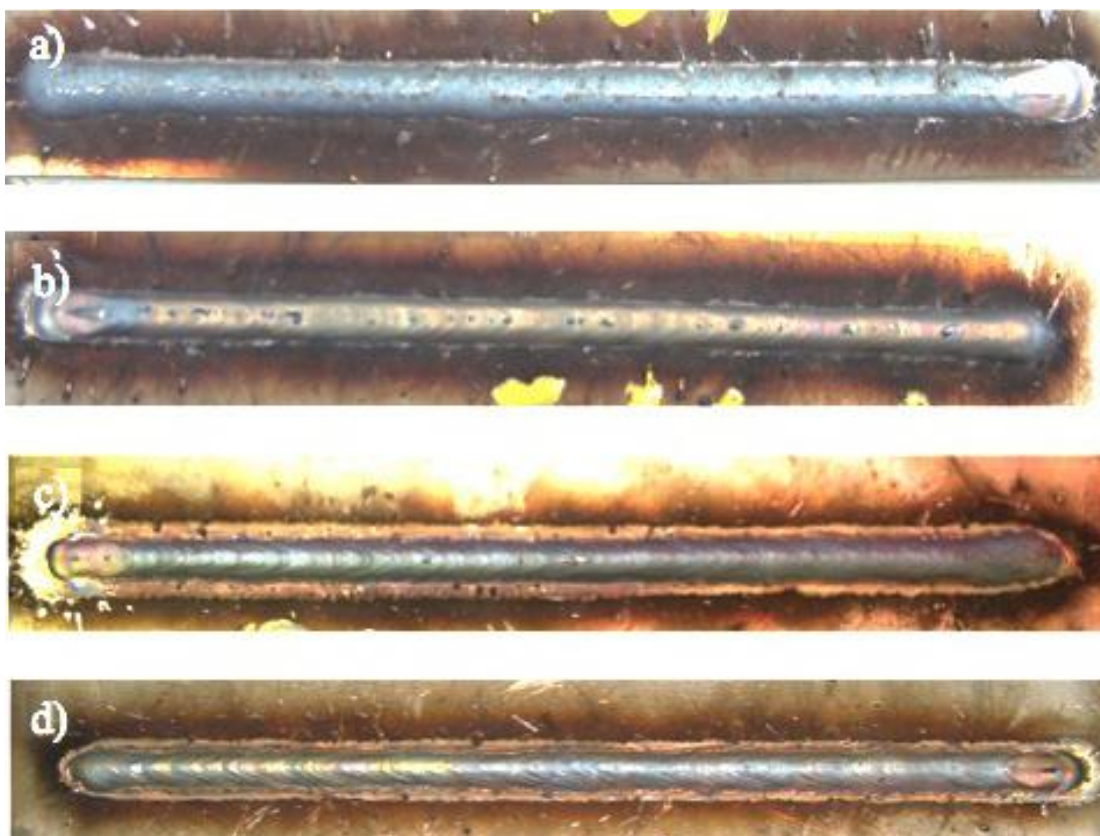
Figura 22: Resultado dos cordões soldados sobre chapa a) sem uso do trailing gas; b) utilizando trailing gas ArH-10; c) utilizado trailing gas NH-10 e d) utilizando trailing gas ArH-15.
