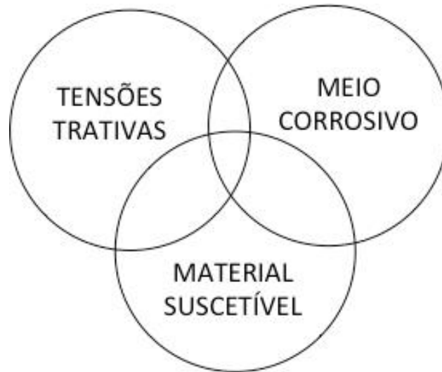
Figura 8: Causas da corrosão sob tensão [24].
