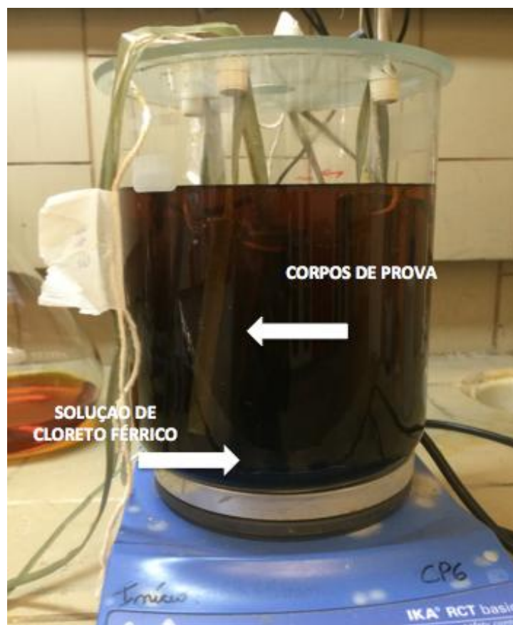
Figura 17: Corpos de prova expostos à solução de cloreto férrico durante ensaio segundo norma ASTM G-48 - Método A.
