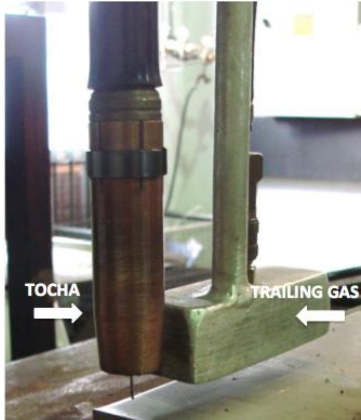
Figura 13: Sistema Trailing Gas
