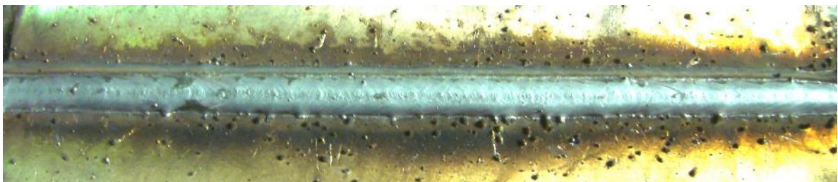
Figura 24: Corpo de prova soldado sem resfriamento até temperatura ambiente entre os passes.
