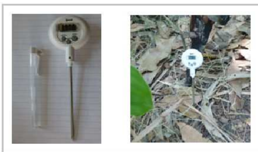
Figura 3.7: Sensor de medida de temperatura da superfície e sua exposição na agrofloresta.
