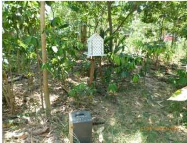
Figura 3.1: Abrigo meteorológico na agrofloresta, que abriga o sensor de temperatura e umidade do ar.
