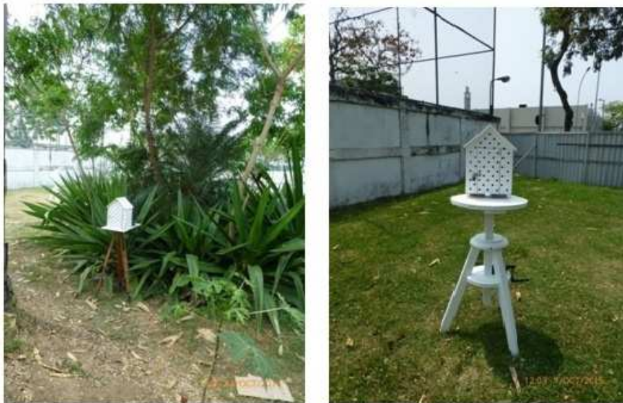
Figura 3.2: Abrigo meteorológico na florestinha e na grama da Estação Meteorológica da UFRJ, respectivamente, que abriga o sensor de temperatura e umidade do ar.
