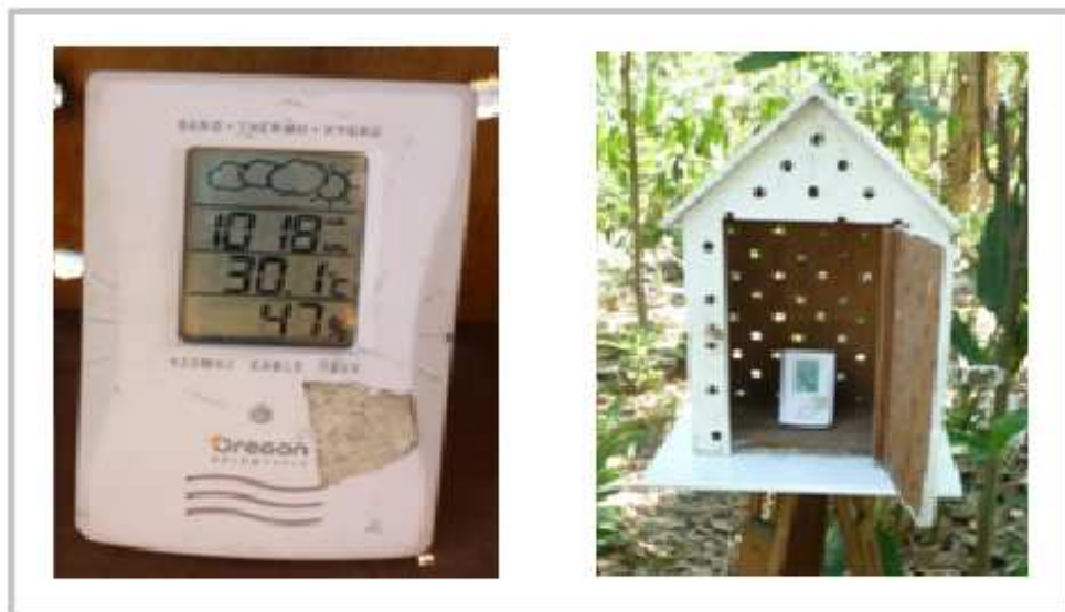
Figura 3.5: Sensor de medida de temperatura e umidade do ar e sua exposição na agrofloresta.
