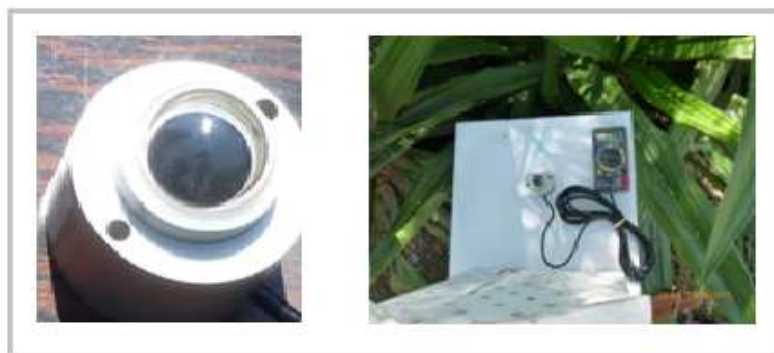
Figura 3.6: Sensor de medida de radiação solar e sua exposição na florestinha.
