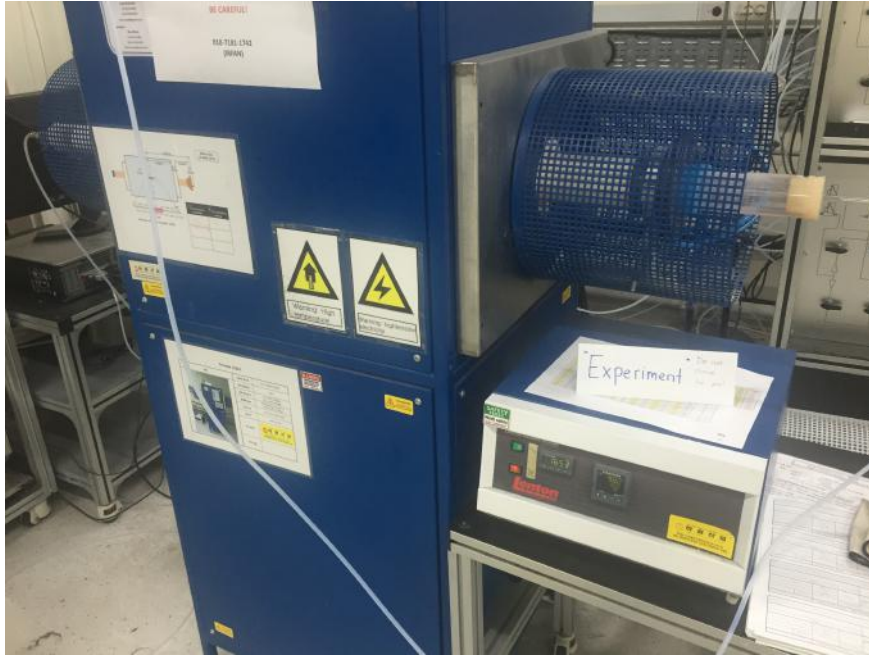
Figura 4.10: Forno horizontal utilizado para o processo de redução.
