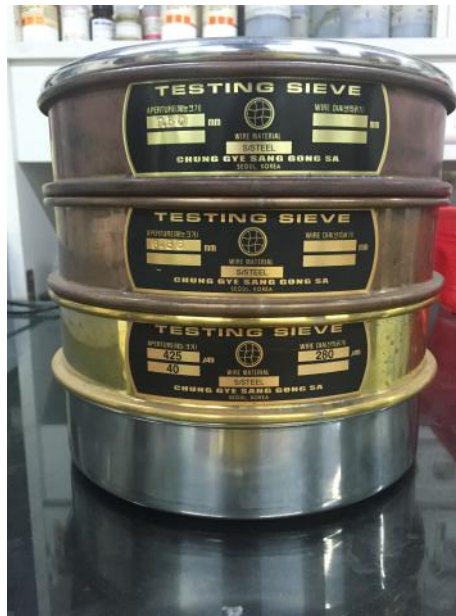
Figura 4.22: Sequência de peneiras para determinação dos índices de abrasão e tamboramento (9,5 mm, 6,3 mm, 0,45 mm).
