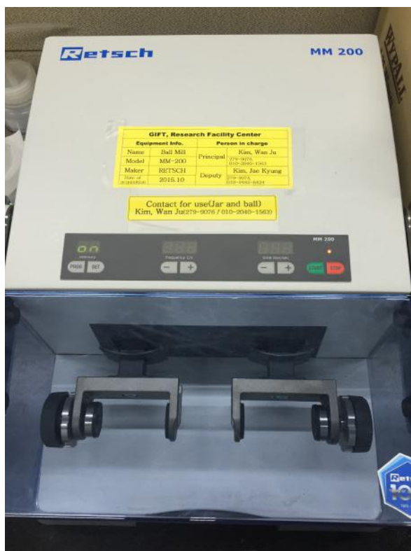
Figura 4.3: Moinho utilizado na preparação das amostras para determinação da composição química.
