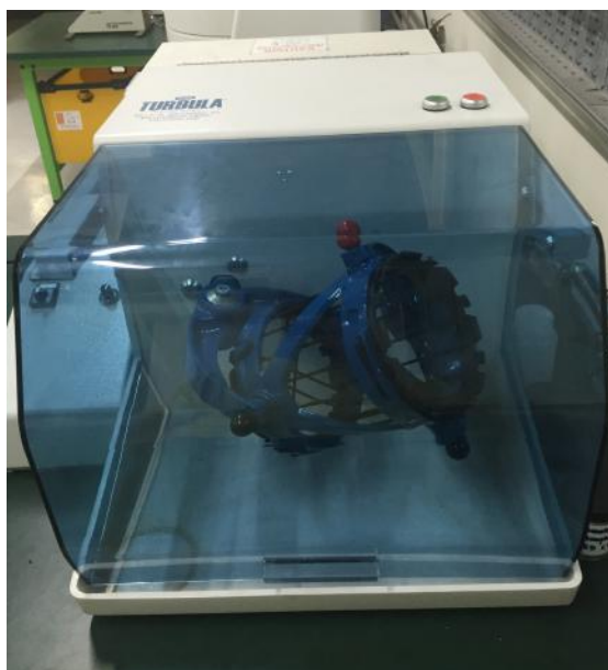
Figura 4.21: Equipamento agitador/misturador WAB Turbula modelo T2F utilizado nos ensaios de tamboramento.
