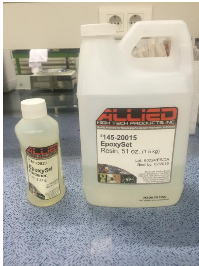
Figura 4.17: Endurecedor e resina utilizados para o embutimento das pelotas (Razão 1:8).
