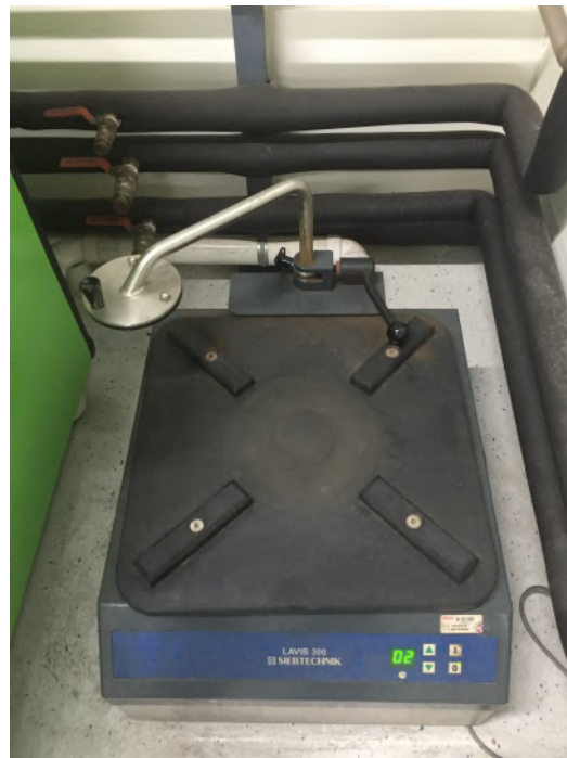
Figura 4.23: Equipamento vibratório utilizado no peneiramento.
