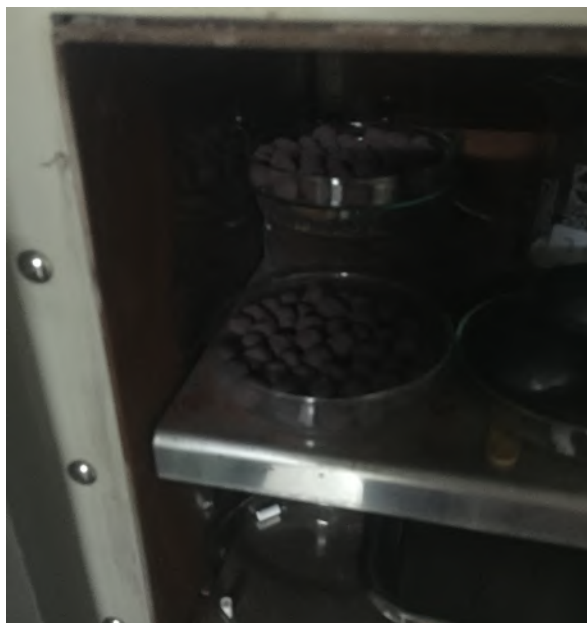
Figura 4.8: Pelotas dispostas no interior do forno para processo de secagem.
