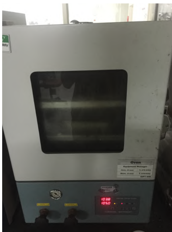
Figura 4.9: Forno mantido a 105°C para secagem das pelotas.
