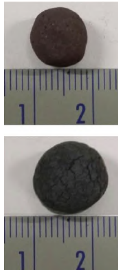
Figura 5.6: Variação morfológica de uma pelota com o processo de redução.
