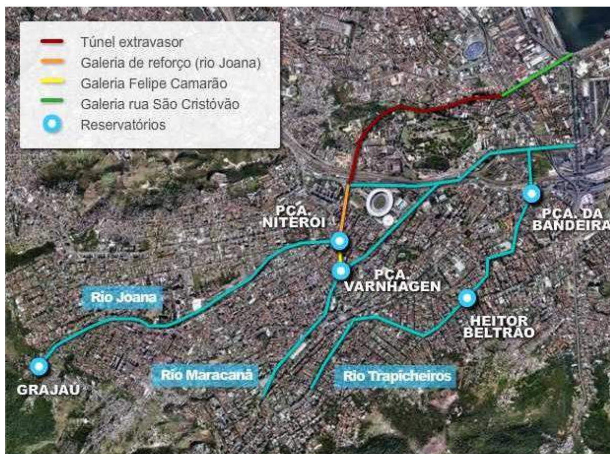
Figura 47 – Identificação dos pontos de localização dos 5 reservatórios, das 2 galerias, e do túnel extravasor. (Fonte: Disponível em < http://www.rio.rj.gov.br/web/rio-aguas >, acessado em junho de 2014)
