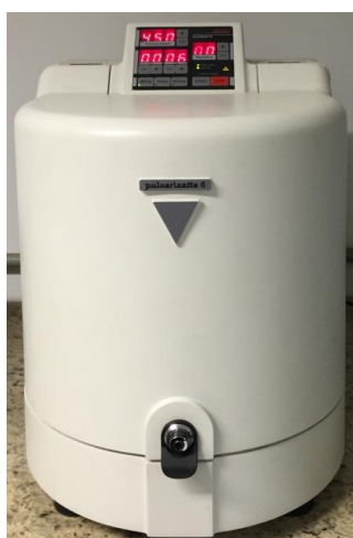
Figura 20 - Moinho planetário Pulverisette 6 utilizado na moagem das amostras
