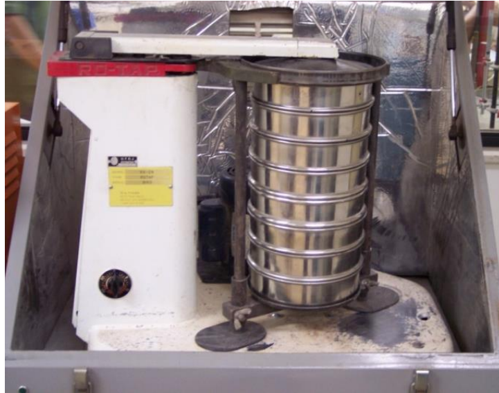
Figura 15 - Aparelho RO-TAP® utilizado para classificar as amostras por peneiramento
