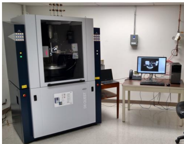
Figura 18 - Difratômetro de raios-X utilizado para a análise de composição mineralógica das amostras de pó de pedra
