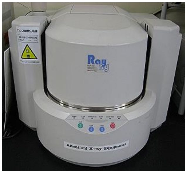
Figura 19 - Espectrômetro de Fluorescência de Raios-X por Energia Dispersiva utilizado nas análises químicas das amostras
