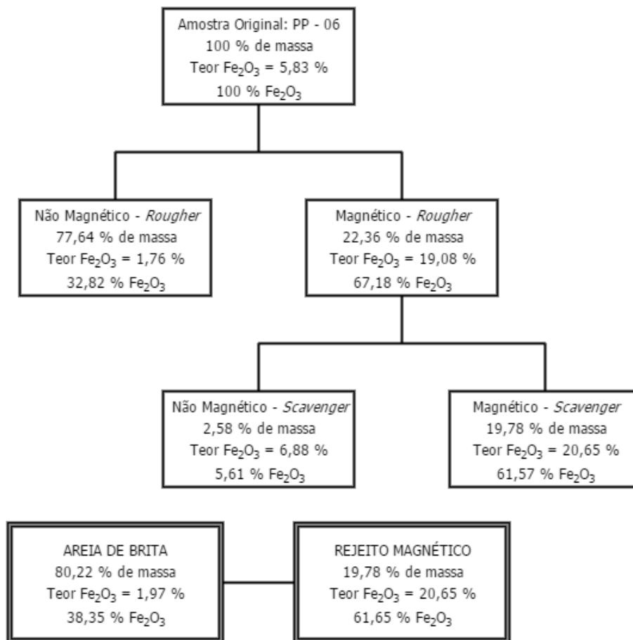
Figura 36 - Balanço de massa e metalúrgico da amostra PP – 06
