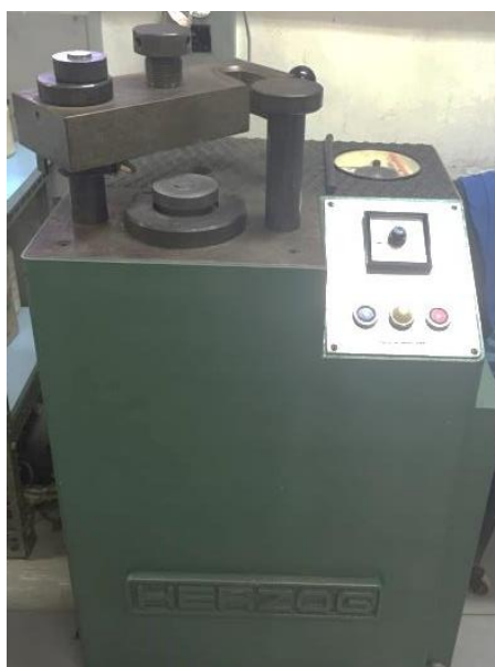
Figura 22 - Prensa semiautomática utilizada para a confecção das pastilhas
