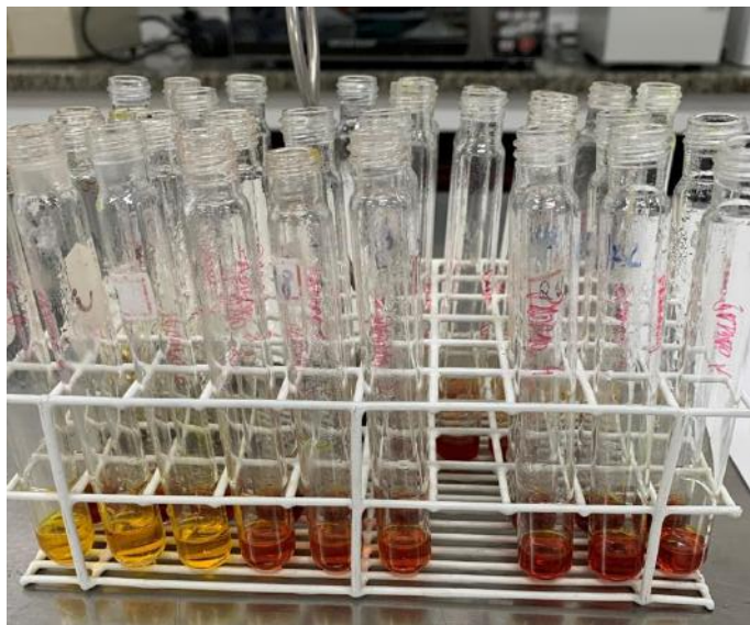
Figura 2 – Quantificação de açúcares redutores pelo método DNS. Curva padrão e amostras (10x, 50x e 100x diluídas), em triplicata.
