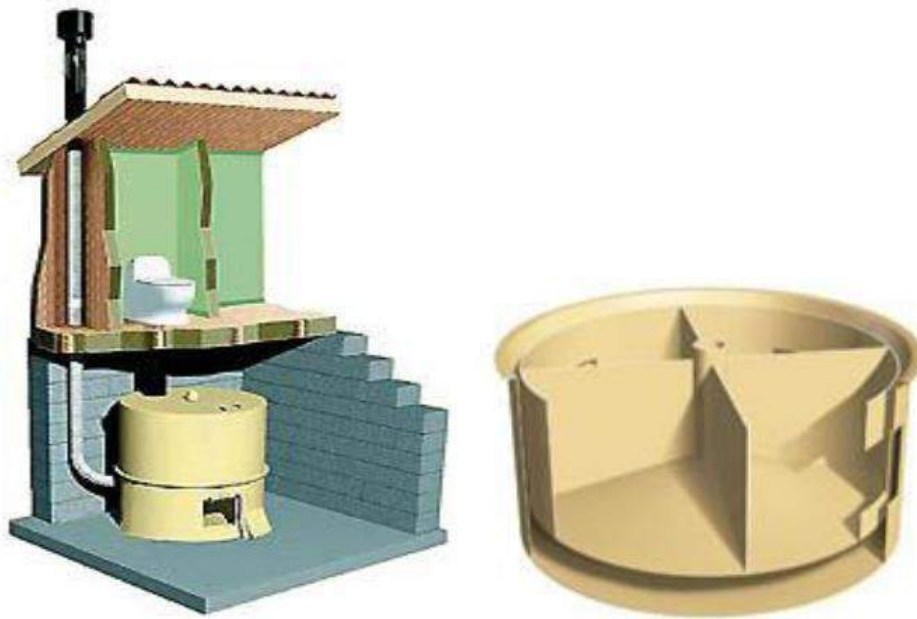
Figura 54 – Sistema de compostagem do banheiro Caracol
