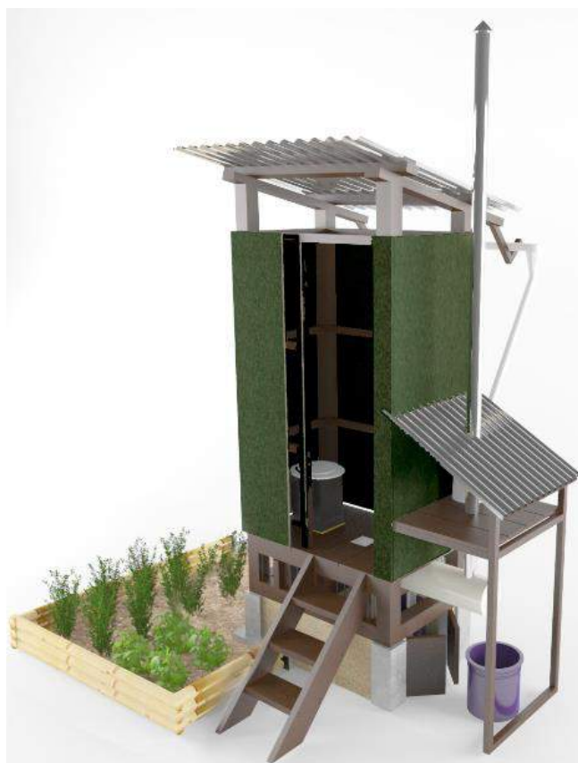
Figura 33 – Protótipo Banheiro seco montado Fundación In Terris Fonte: FUNDACIÓN IN TERRIS, 2012
