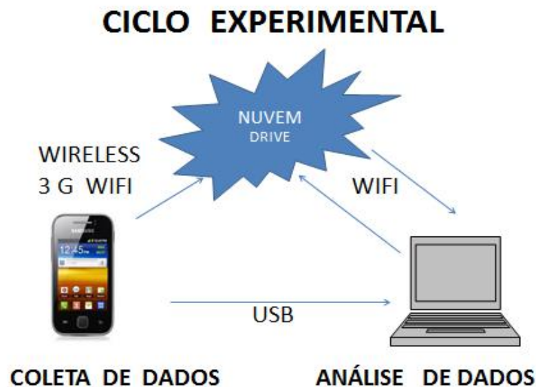
Figura 3.1: Tomada de dados através do smartphone no experimento efetuado e posterior envio para análise e representação gráfica no computador.
