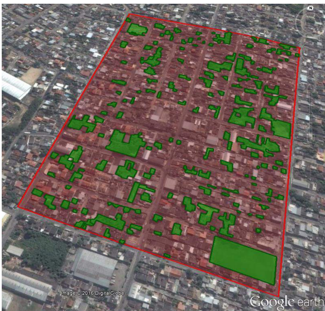
Figura 32. Demarcação das áreas consideradas permeáveis para estimativa da porcentagem de impermeabilização do solo na região de estudo Fonte: GOOGLE (2016)
