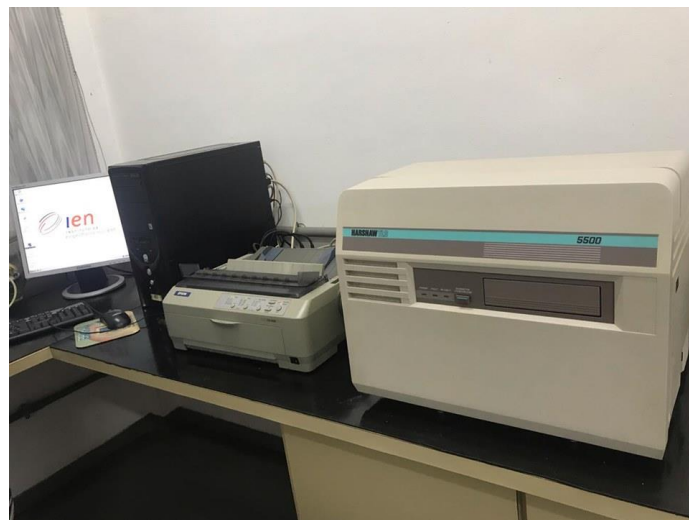
Figura 10. Leitora Harshaw e o sistema TLDShell instalado ao microcomputador. Fonte: Arquivo pessoal.
