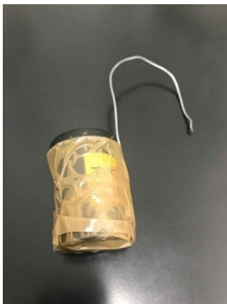
Figura 24. Armação para o encaixe do dosímetro junto ao monitor de área. Fonte: Arquivo pessoal.
