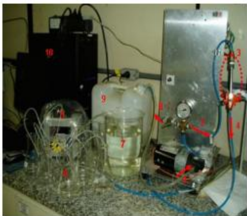
Figura 5: Representação do esquema utilizado em laboratório para colunas de adsorção. De acordo com o esquema: 1) Bombona de alimentação, 2) Bomba de diafragma, 3) Corrente de efluente destinado à coluna, 4) Corrente de efluente que retorna à bombona de alimentação, 5) Monômetro, 6) Coluna de Carvão Ativado, 7) Coletor automático, 8) Erlenmeyers para coleta da amostra, 9) Becker de descarte e 10) Computador com programação de coleta das amostras. Fonte: MACHADO (2013).
