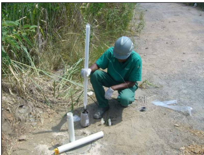
Figura 19: Técnico realizando a coleta de água subterrânea com o amostrador bailer Fonte: Autoria própria.
