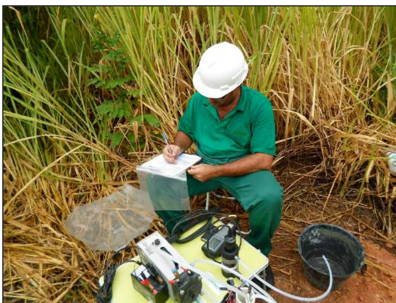
Figura 20: Técnico realizando a coleta de água subterrânea pelo método de baixa vazão Fonte: Autoria própria.
