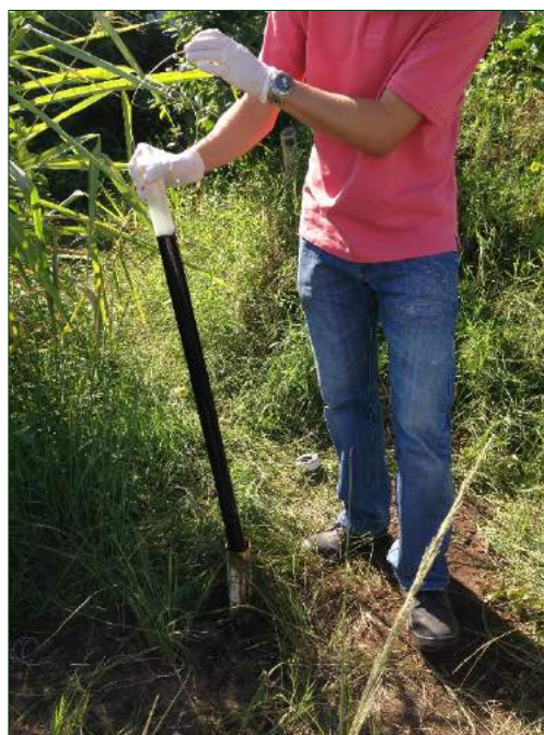
Figura 8: Fase livre de produto oleoso detectada no poço de monitoramento PM-10 Fonte: Autoria própria.
