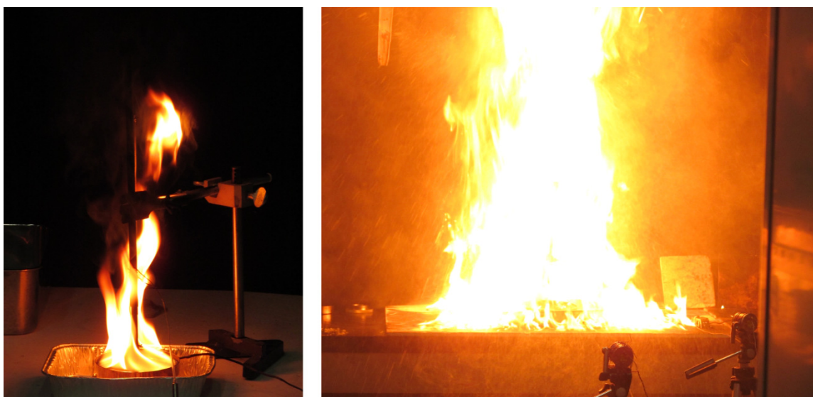
Figura 9.31: Fotografias de um dos experimentos realizados. À esquerda, combustão durante a fase semi-estável; à direita, boilover .
