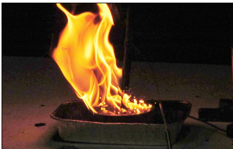
Figura 9.44: Fotografia da combustão do petróleo com a subcamada de água em estado inicial de ebulição.
