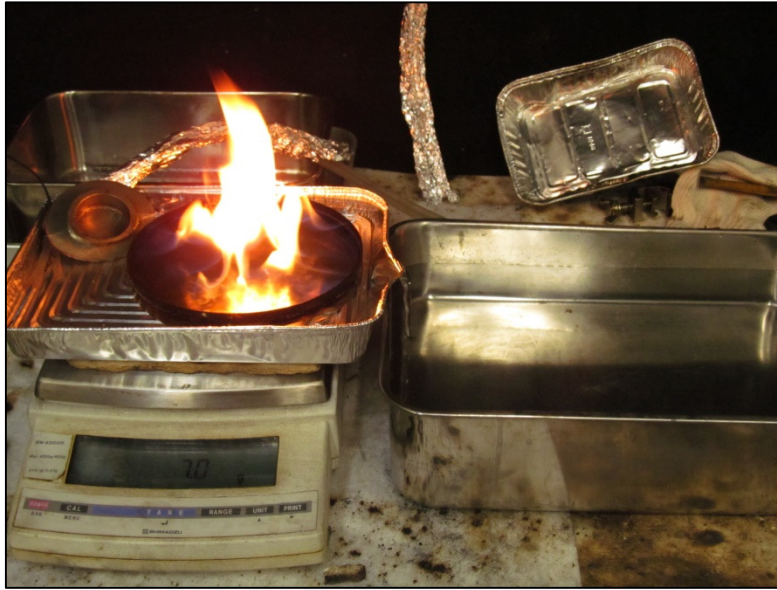
Figura 9.1: Imagem da medição de velocidade de combustão de experimento em Cenário III-b 1 .
