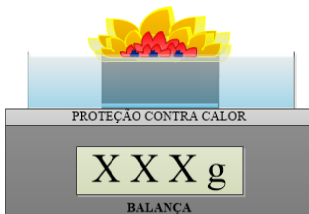
Figura 8.5: Exemplo de esquema de medição da evolução da massa de combustível ao longo do tempo.
