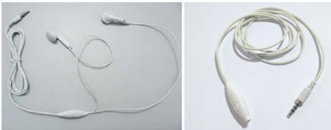
Figura 4.14 - Fones de ouvido da marca Motorola. A esquerda 8 o fone da maneira que é entregue ao consumidor e a direita customizado para servir de microfone de lapela.
