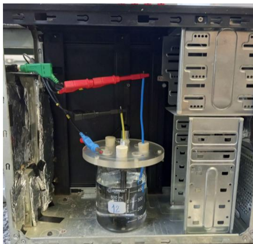
Figura 3-12 Esquema de montagem do processo de espectroscopia de impedância eletroquímica dentro de uma gaiola de Faraday feito na bancada.
