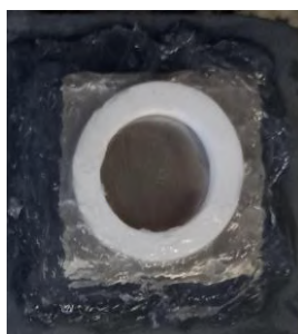
Figura 3-9 Anel de silicone utilizado para vedar a área exposta da superfície metálica.
