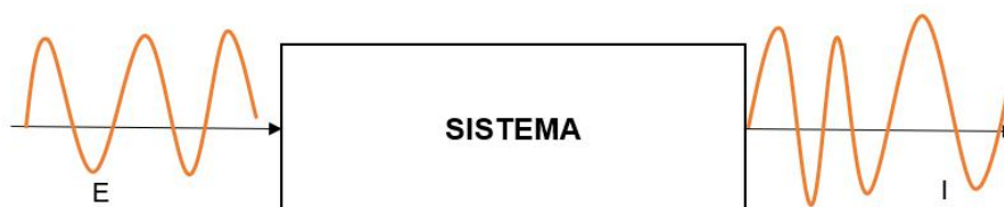
Figura 2-13 Representação esquemática de sinal de perturbação em um sistema e sua resposta.
