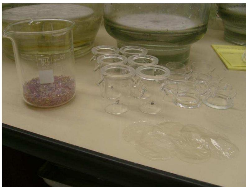
Figura 15: Filmes de alginato e sílica; conjuntos desmontados após seis dias de experimento.
