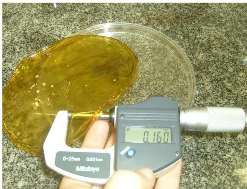
Figura 5: Micrômetro digital e um filme de CMC.
