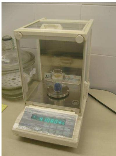
Figura 10: Balança analítica eletrônica com precisão de quatro casas decimais de grama.
