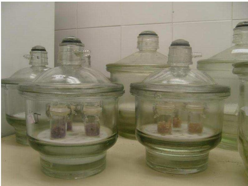
Figura 14: Evolução após seis dias de experimento: filme de CMC em meio de água destilada pura à direita e em meio de solução supersaturada com NaCl à esquerda.
