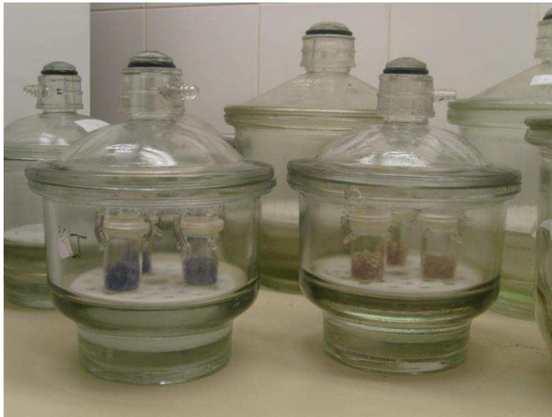
Figura 13: Evolução após três dias de experimento: filme de CMC em meio de água destilada pura à direita e em meio de solução supersaturada com NaCl à esquerda.
