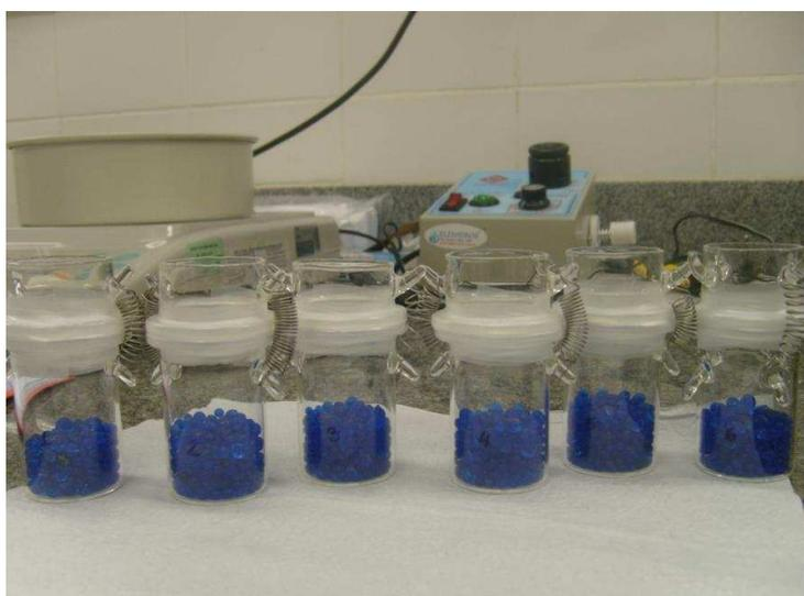
Figura 9: Conjuntos montados: células cilíndricas contendo sílica e seladas com o filme.
