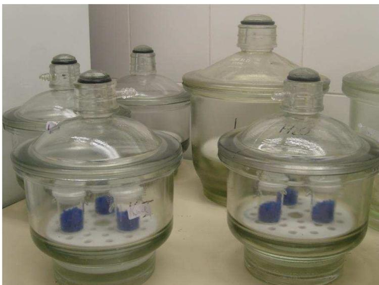
Figura 11: Foto dos dois conjuntos; à esquerda observa-se o dessecador com solução supersaturada de NaCl e à direita, o dessecador com água pura.
