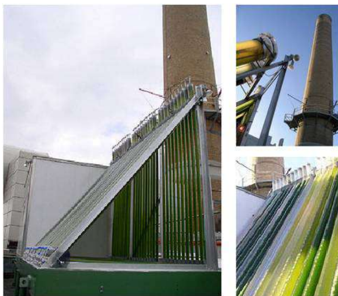
Figura 33: Detalhes do fotobioreator da GreenFuel Technologies utilizado no teste de campo no MIT (Massachusetts Institute of Technology)
