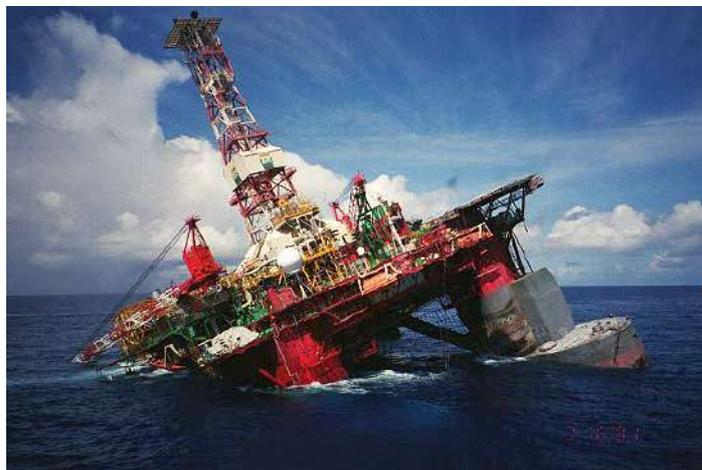
Figura I.1 – Plataforma P-36 ao adernar após o acidente. Blue Star Line (2008)
