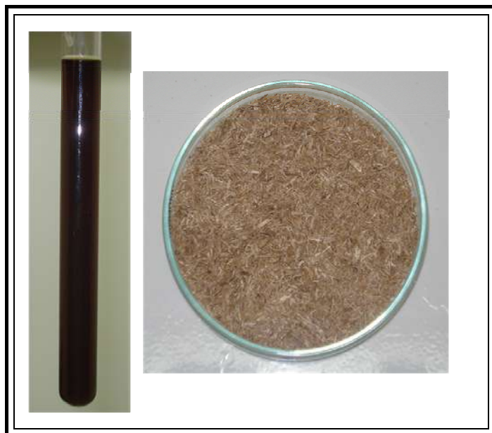
Figura 5.1.4: Frações líquida e sólida após deslignificação com ác.acético/ác.fórmico
