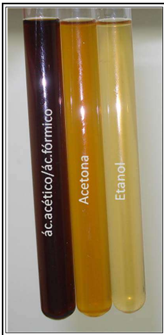
Figura 5.1.1: Fração líquida após deslignificação organosolv
