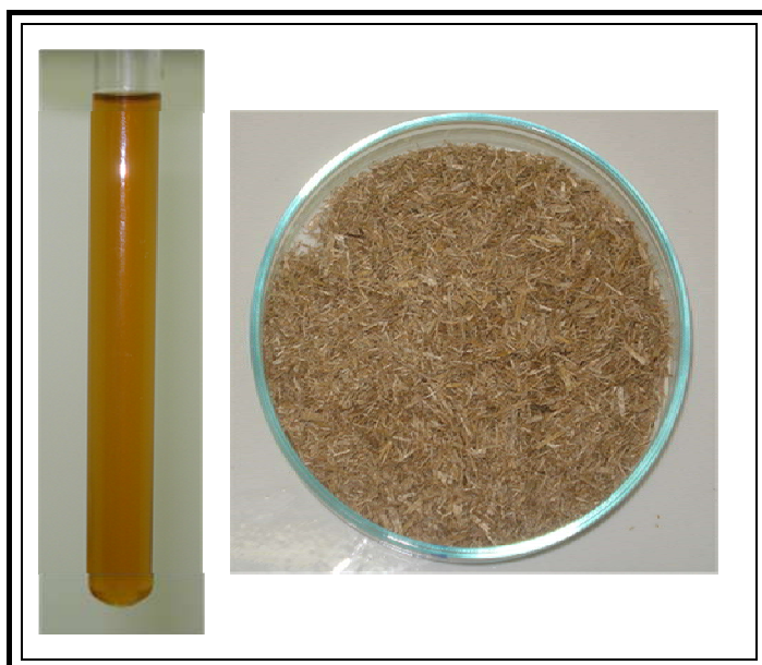
Figura 5.1.5: Frações líquida e sólida após deslignificação com acetona
