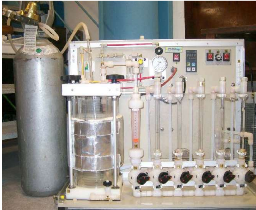
Figura 3: Foto mostrando o cilindro de CO 2 acoplado ao sistema looping .
