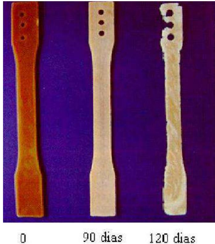
**Figura 3.7 - Corpo de prova produzido com P(3HB) em decomposição em fossa séptica.**
