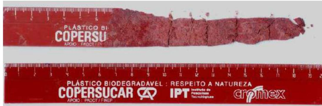
**Figura 3.6 - Régua produzida a partir de P(3HB) em processo de biodegradação.**
