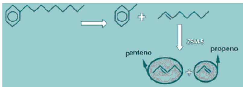
Figura 5.12 - Reatividade de cargas pesadas no FCC Petroquímico. Fonte: PINHO (2005)
