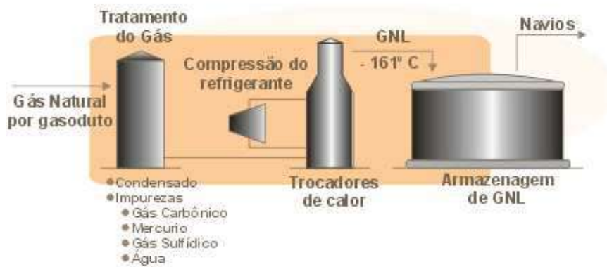
Figura 1.7 – Unidade de liquefação (Souza, 2007)
