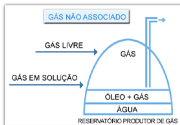
Figura 1.2 - Reservatório de Gás Não Associado (CONPET, 2004)
