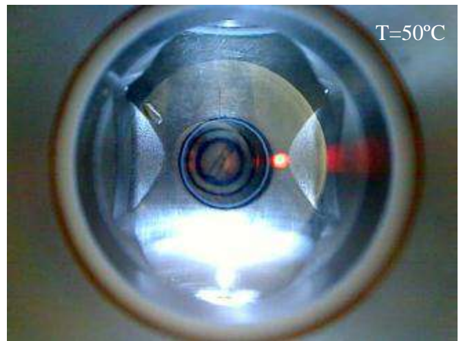
Figura 3.14 – Sistema com 80% massa de etanol no ponto de bolha
