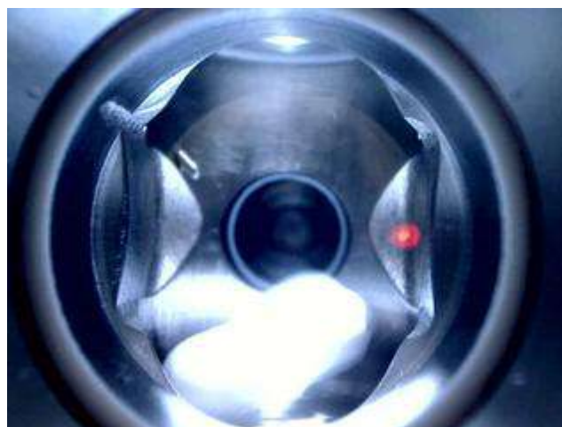
Figura 3.15 – Sistema rico em \text{CO}_2 (80% massa) todo na fase líquida
