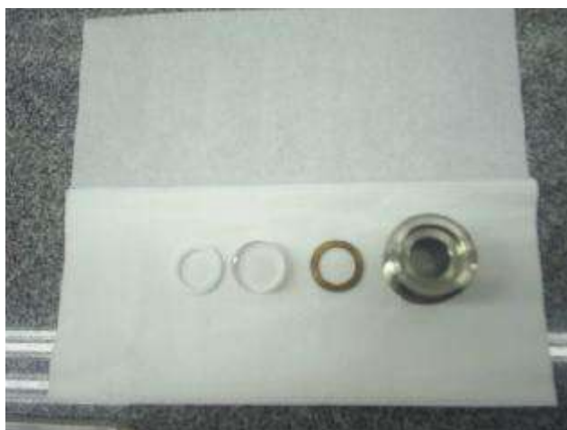
Figura 3.6 – Montagem do visor frontal de safira – anel de teflon/janela de safira/ anel de cobre/ rosca para fechamento
