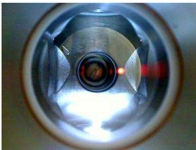
Figura 3.13 – Sistema rico em etanol (80% massa) todo na fase líquida
