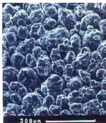
Figura 2.13. Micrografia de uma placa porosa de plástico. Fonte: EGFILTROS, 2009.
