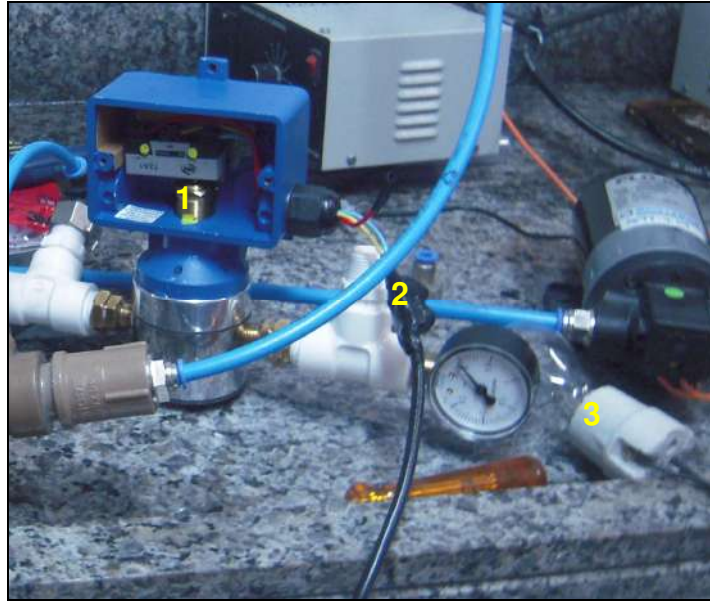
Figura 3.7. Interior do pressostato e ligação elétrica feita com a lâmpada incandescente: 1 – Rosca de ajuste do “set-point”; 2 – Ligação elétrica do circuito interno do pressostato; 3 – Lâmpada incandescente.
