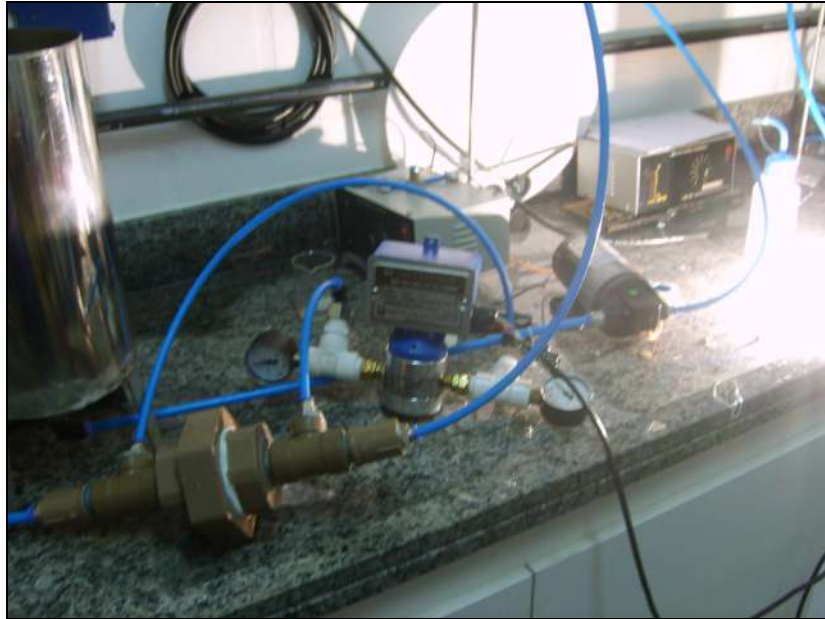
Figura 4.8. Funcionamento do pressostato no escoamento da suspensão de 5000 mg/L.
