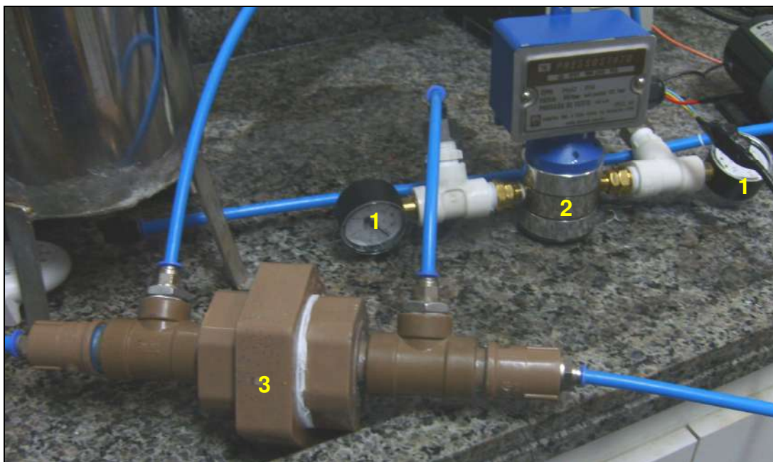
Figura 4.7. Dispositivo para intertravamento: 1 – Manômetros de 0 a 2,5 bar; 2 – Pressostato diferencial com ajuste de “set-point” até 2 bar; 3 – Corpo do dispositivo.
