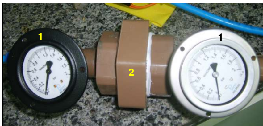
Figura 4.1. MPD: 1 – Manômetros de 0 a 2 Bar; 2 – Corpo de PVC
