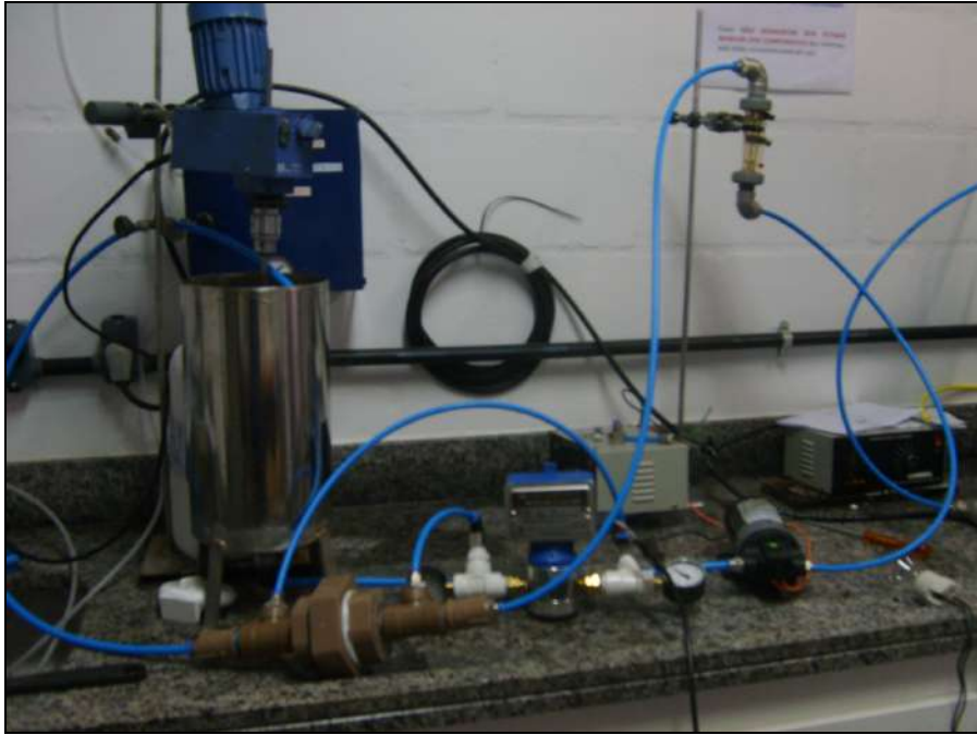
Figura 3.6. Sistema utilizado para calibração do pressostato e para os testes de validação do dispositivo de intertravamento.
