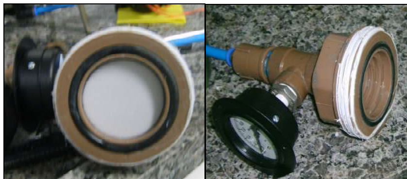
Figura 4.2. Interior do MPD com e sem placa porosa respectivamente.
