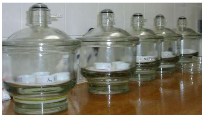
Figura 4.2 Experimentos de sorção do camu-camu em pó pelo método estático gravimétrico. T=25 ± 1°C.
