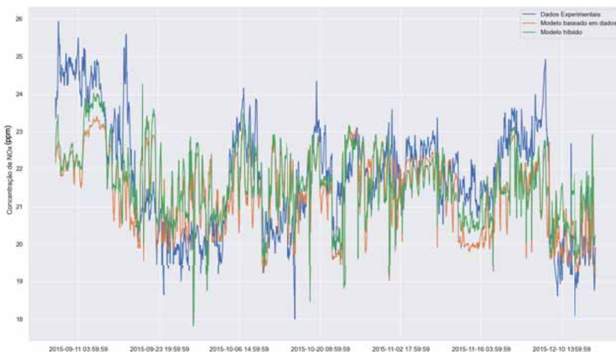
Figura 4.1: Resultados para a estimação do \text{NO}_x do melhor modelo baseado em dados (SNN) e híbrido (Deep FFNN), comparados contra os dados experimentais.
