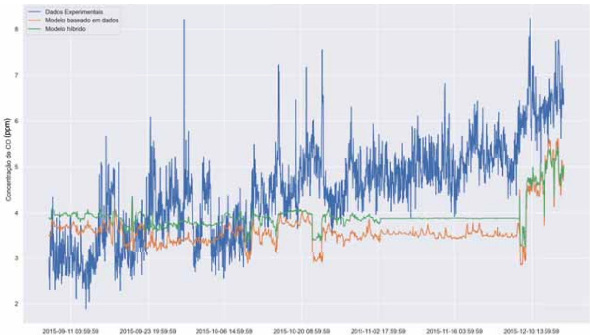
Figura 4.3: Resultados para a estimação de CO do melhor modelo baseado em dados (SNN) e híbrido (Deep SNN), comparados contra os dados experimentais.
