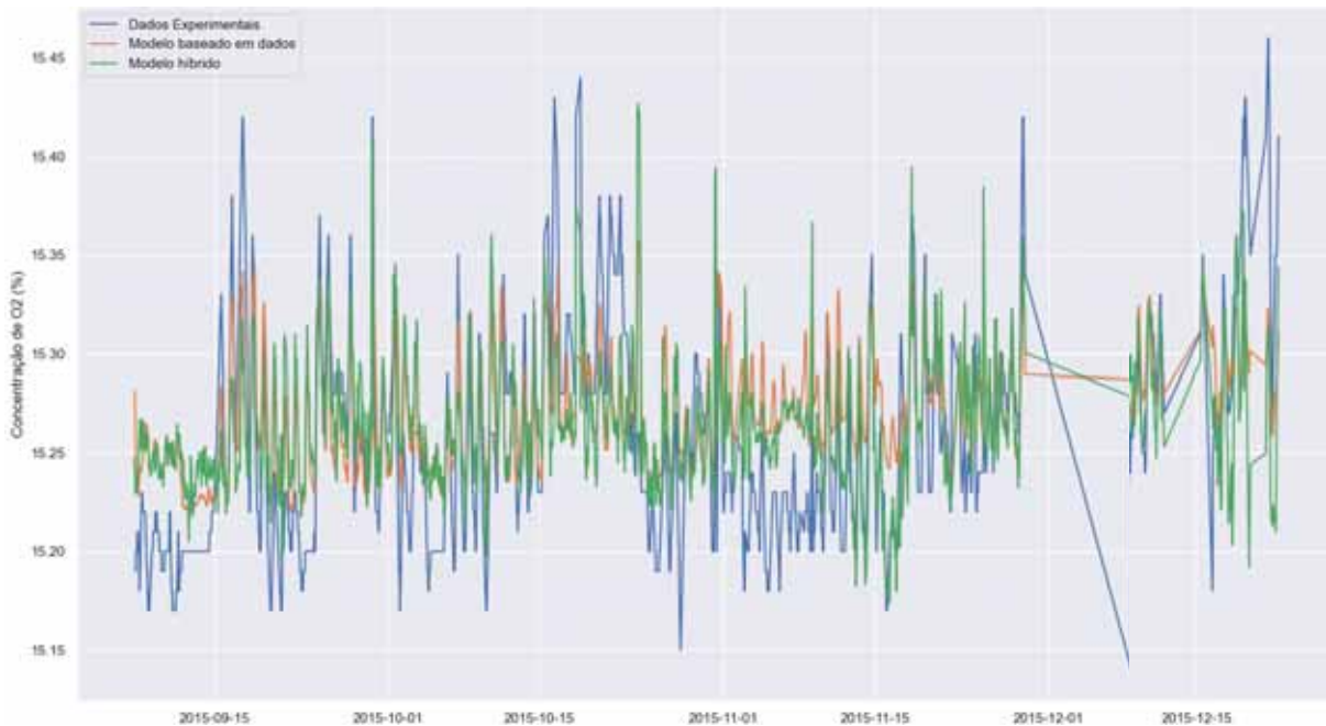
Figura 4.2: Resultados para a estimação de \text{O}_2 do melhor modelo baseado em dados (RNN) e híbrido (NN-MQ), comparados contra os dados experimentais.
