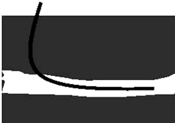
**Figura 2.1.** Esquerma dos poços horizontais - Maior contato com o reservatório/acompanha camadas finas (modificado de Prado, 2003)
