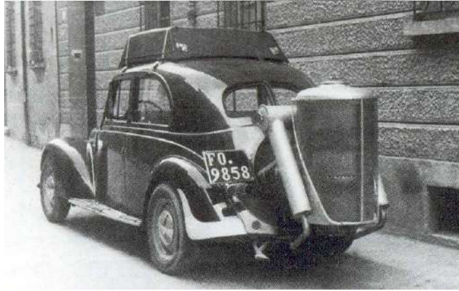
Figura 2-1. Veículo da década de 1940 equipado com gasogênio (Fonte: Wikipédia, 2008)
