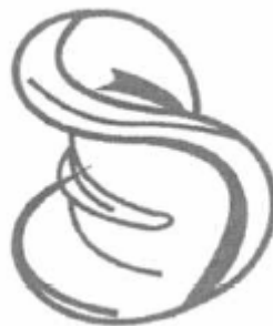
Figura II.13 : Esquema da Sela de Berl (CALDAS et al , 2003)
