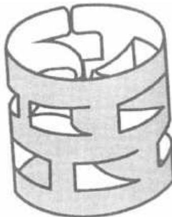
Figura II.15 : Esquema do Anel Pall (CALDAS et al , 2003)
