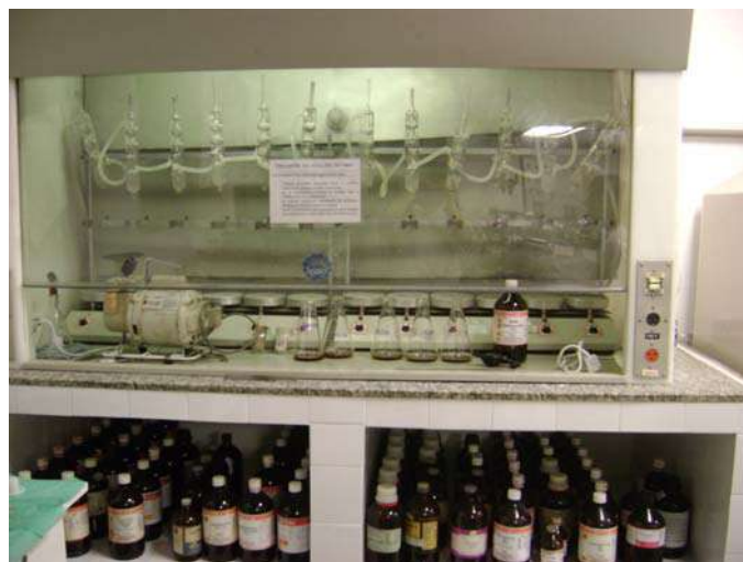
Figura 8: Foto da preparação da amostra para análise de matéria orgânica.
